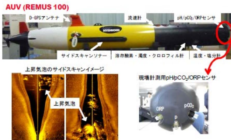
図 2-49 各種現場型化学センサー搭載 AUV
