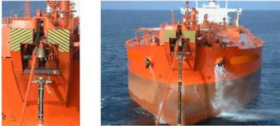
図 2-40 Bow Loading System の例
