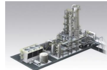
CO2回収実証プラント(建設中) 1日500トン以上回収(2020年運転開始予定)
