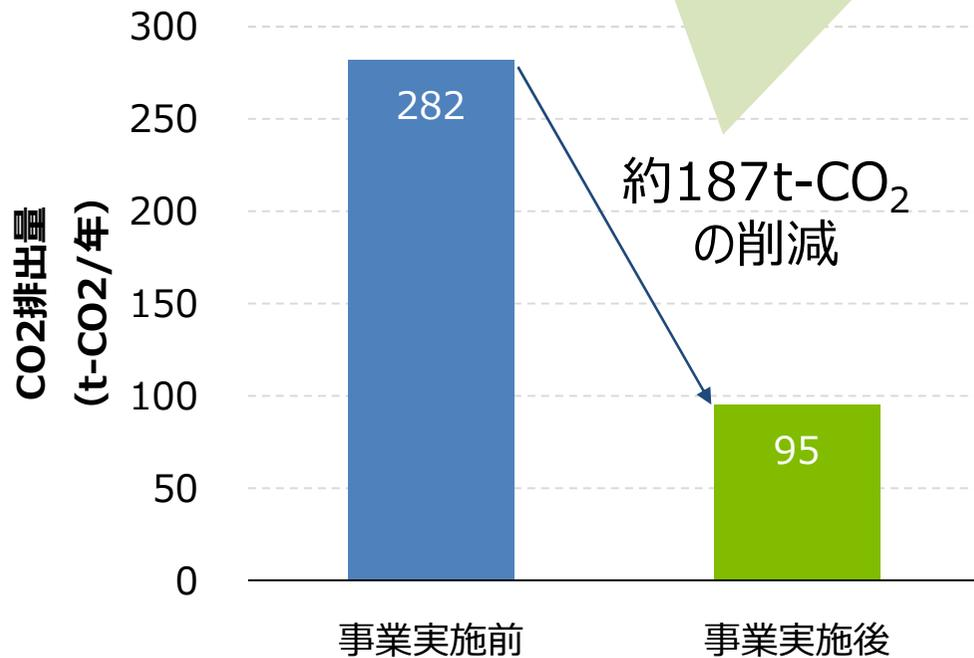
配水ポンプの運転時間の低減により、電気料金を約1/3に削減できた。
