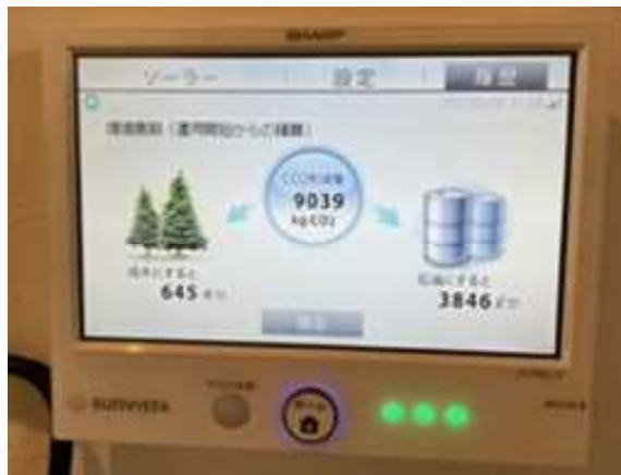
BEMSモニタで発電状態、放電状態、蓄電状態、CO 2 削減量を 確認しながら、運用改善の検討を実施
