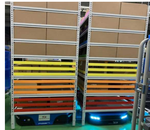
無人搬送機 (Automatic Guided Vehicle : AGV) と移動棚
