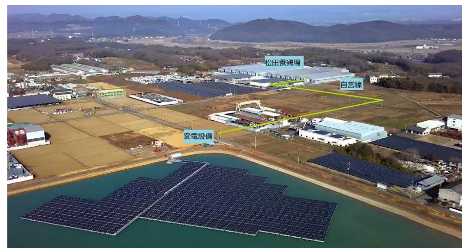
図 水上太陽光発電から松田養鶏場への自営線の写真
