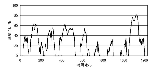
車両総重量3500kg超の車両の試験モードの基となる代表走行モード
