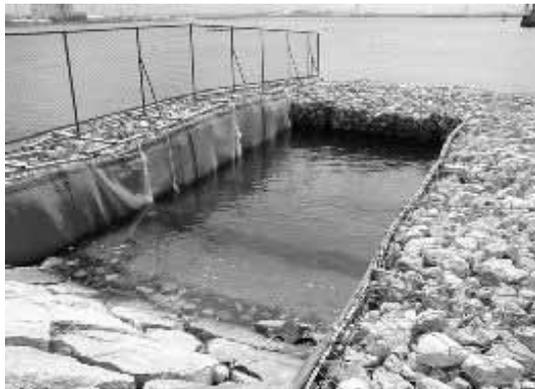
石積堤を用いた閉鎖性干潟実験施設
