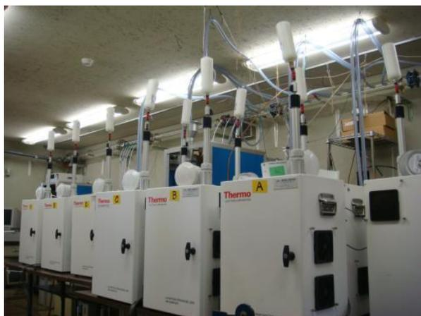
図2 へパフィルタによるゼロ試験
