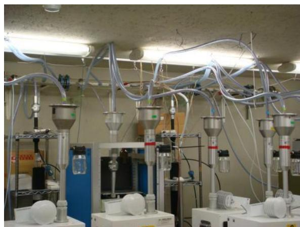
図3 集合配管から分粒装置への配管
