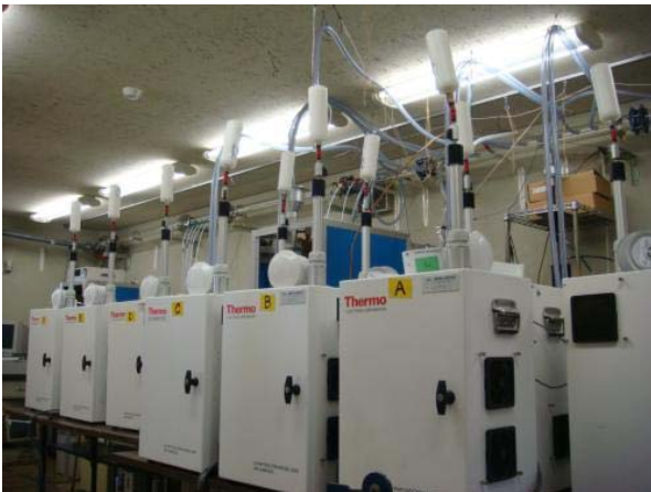
図2 ヘパフィルタによるゼロ試験
