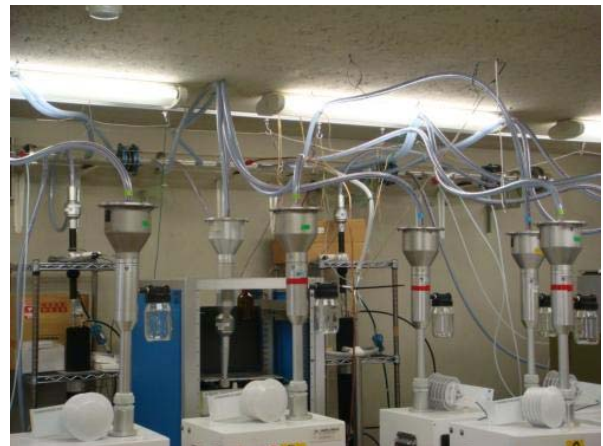
図3 集合配管から分粒装置への配管
