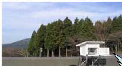
山間部や都市部に設置した花粉自動計測器により、リアルタイムで花粉飛散数を測定するとともに、そのデータを自動送信しており、常に最新の情報がホームページからご覧いただけるようになっている。
