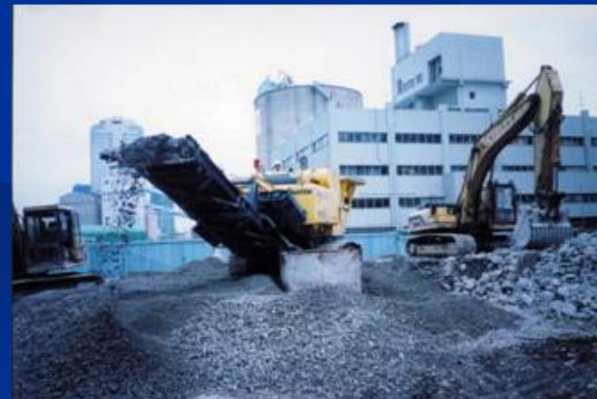
移動式破砕機で再生碎石を製造
