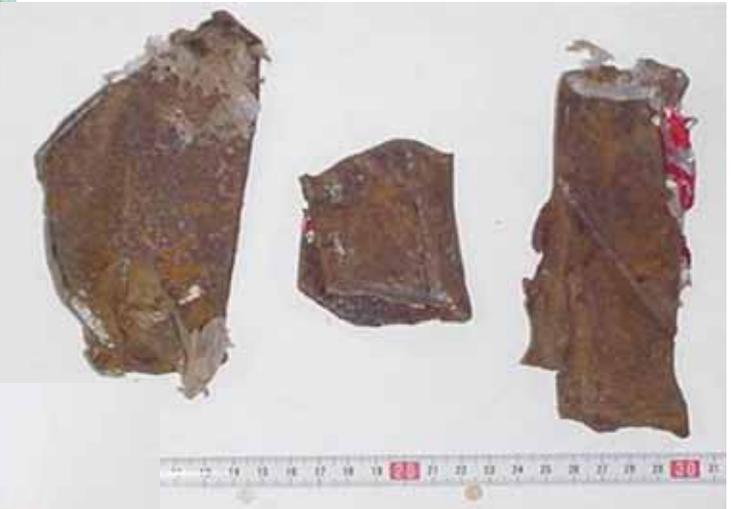
異物除去ができず破砕機で切断してしまった金属
