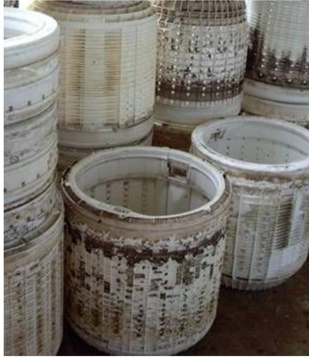
写真 洗濯・脱水槽(内槽)
