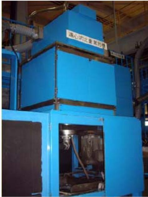
混合プラスチックから高精度にPP(ポリプロピレン)樹脂を選別・回収するための技術
