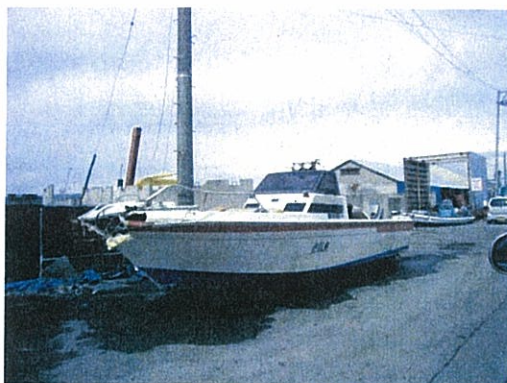
先端のみが損傷している船舶の例
