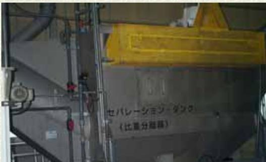
⌘ 水に沈んだ物を不適物とし、水に浮いた比重の軽いものだけを選別します。
