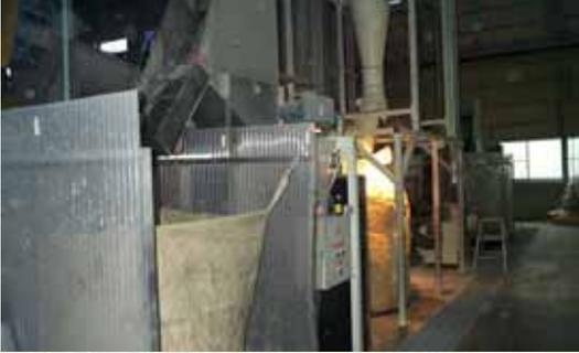
✦ フレーク(ボトル類・肉厚の固形類)をフレコンに詰めて出荷します。
