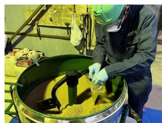
モルタルミキサーによる 土壌均一化作業
