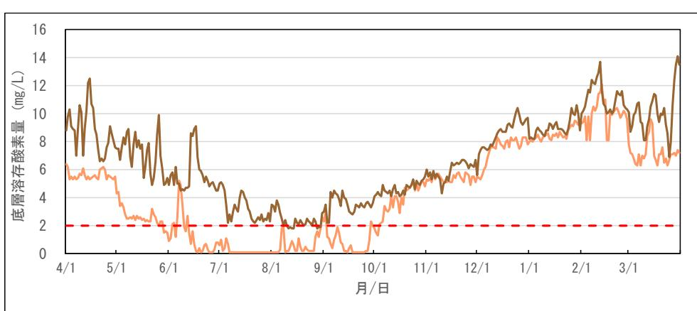
参考図2 連続測定地点の底層溶存酸素量の測定結果の例
