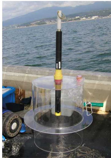
底泥と底層水の酸素消費速度測定のために海底に設置したベルジャー（木元ら2003）
