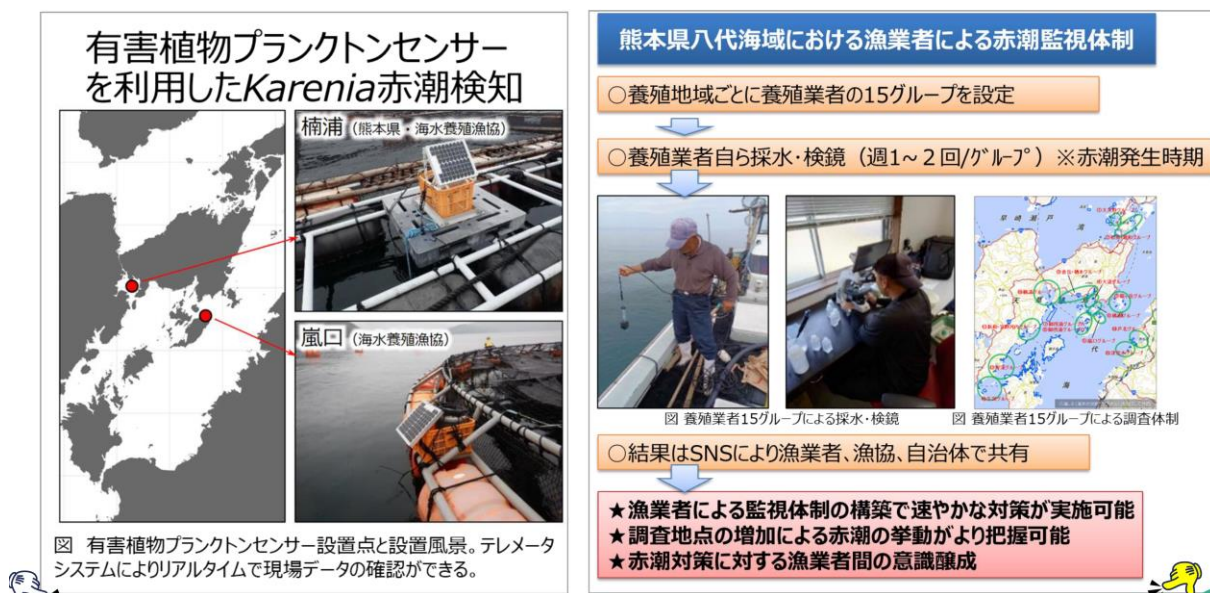
付図 5.4.2-1 有害植物プランクトンセンサーを利用した Karenia 赤潮検知 及び熊本県八代海域における漁業者による赤潮監視体制
