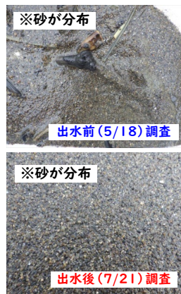
付図 3.2.3-9 横断形状と河床材料の変化(筑後川4k地点)
