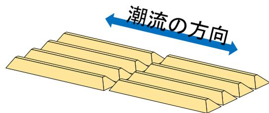
図 凹凸覆砂畝型漁場の施工イメージ
