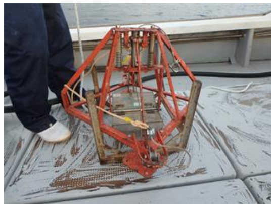
図1 ベントス・底質の試料採取状況
