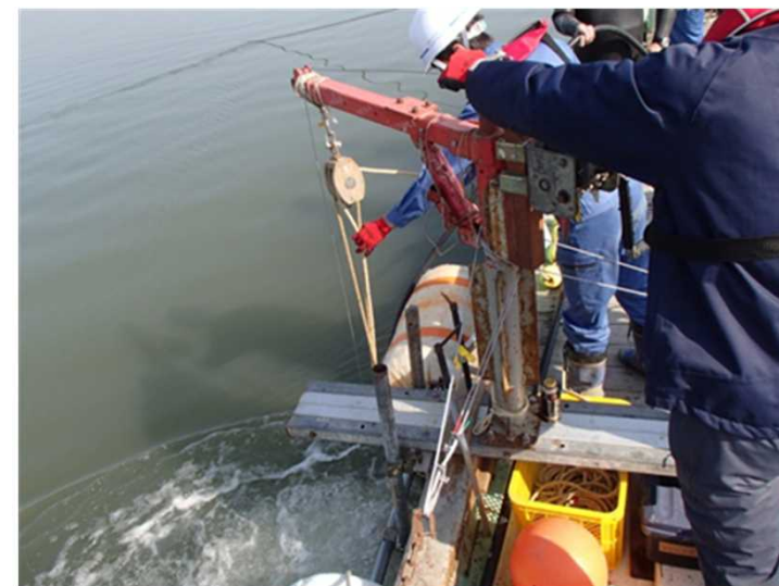
河床堆積構造調査（コアサンプリング）状況
