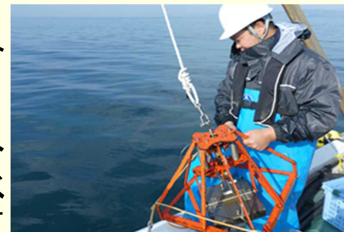
底質・底生生物の試料採取状況
