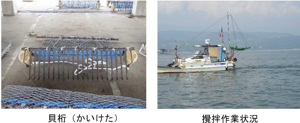
図 1.1-1 貝桁と貝桁による攪拌作業の状況
