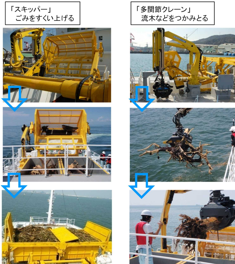
図 2.1-2 海輝・海煌による漂流ゴミ回収作業の状況
