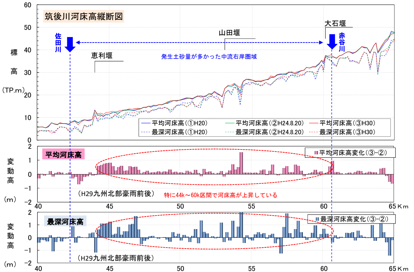
図 2.2.3-4 平成 29 年 7 月九州北部豪雨災害後の筑後川(河床高の変化)
