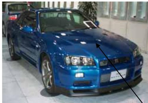
自動車エンジンフード CFRP
