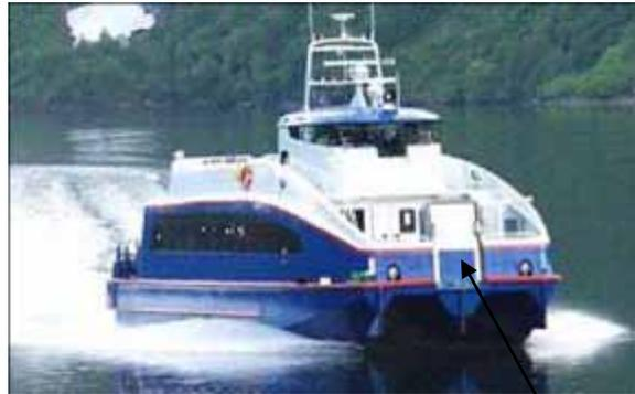
フェリー船体 CFRP
