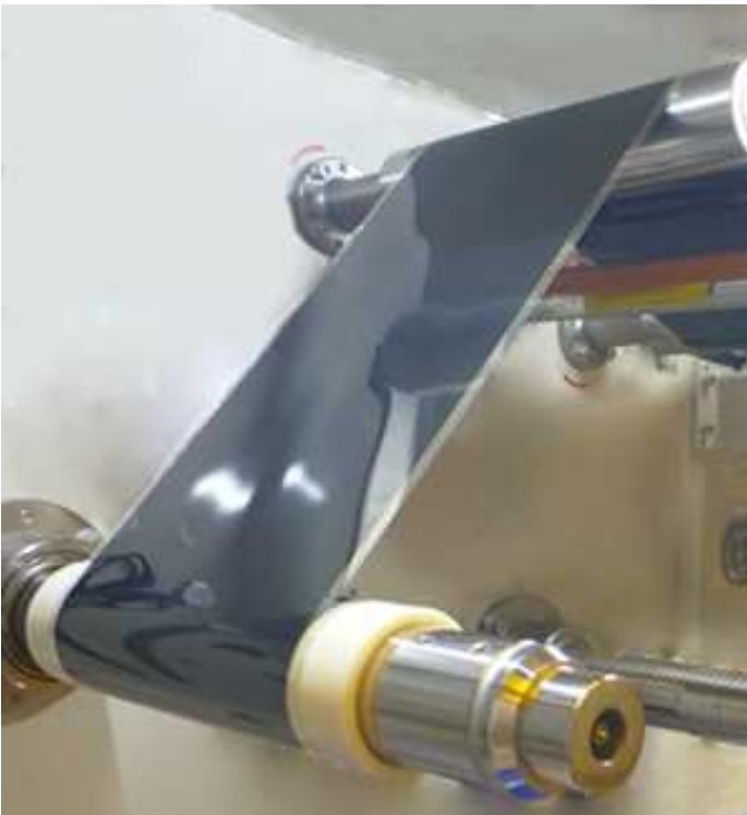
ロールtoロールによる製造
