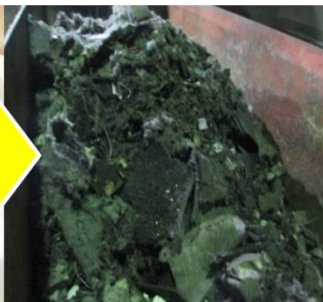
ブリケットを電炉に投入
