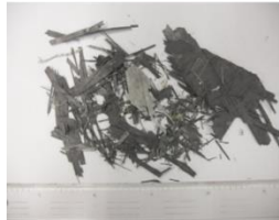
破碎後の水素タンク
