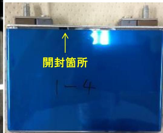
セルケース/蓋の溶接部を刃具で切削し開封
