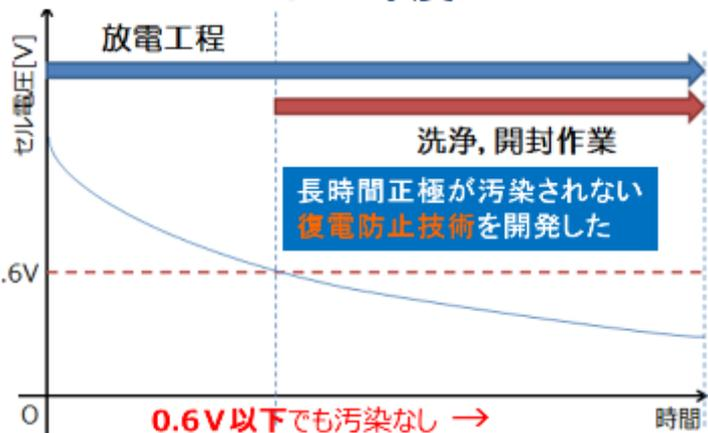
正極（ニッケル・コバルト）が汚染されないように残電圧を有する電池を安全に分解できる技術を確立できた
