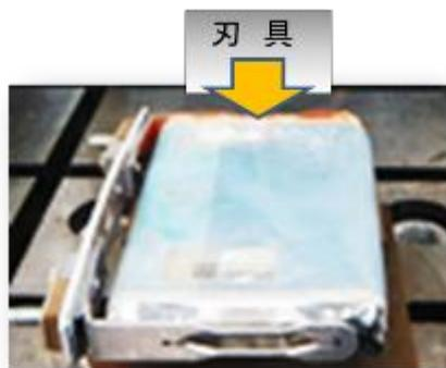
電極を集電体から自動で切り離すために必要な刃具の最適形状を検証し、切り離し圧力を定量化出来る機械による切断技術を確立できた
