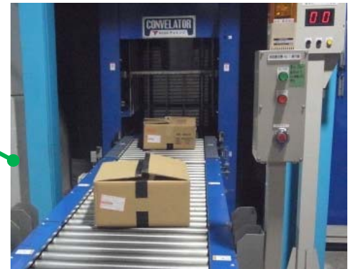
焼却炉への投入(一例) 焼却炉に投入される廃発炎筒 入り専用箱。
