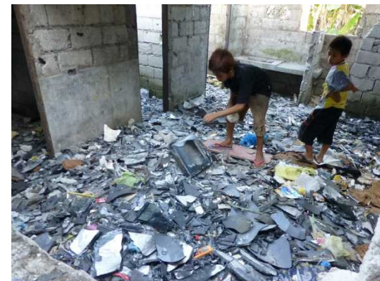
子供が素手とサンダルで CRTの破壊作業 。シャドウマスクと電子銃を回収して、親に渡していた。
