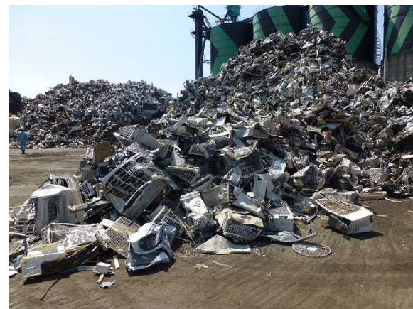
港湾施設でエアコンを重機で 破壊(フロン類放出)
