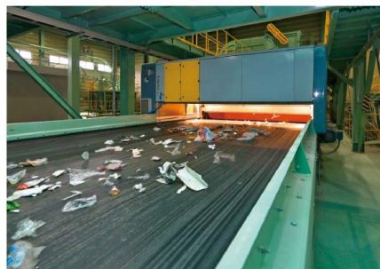
最新の光学センサーを用いて樹脂素材の選別を行う
