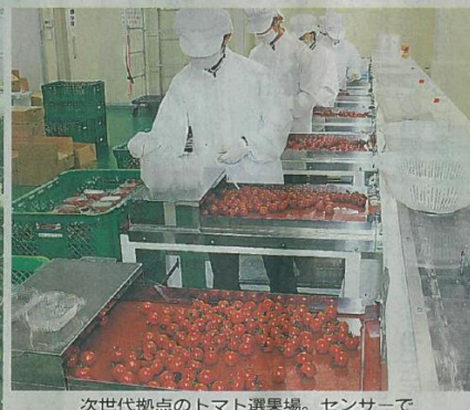
次世代拠点のトマト選果場。センサーで糖度をチェックし、基準を満たしたものをだけ出荷している。富山市婦中町吉谷
