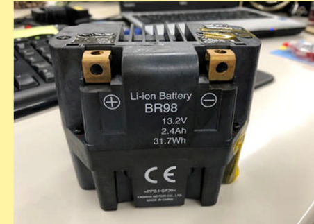
2輪用始動用Li-ionバッテリー(ヤマハ) (外寸90×110×70)
