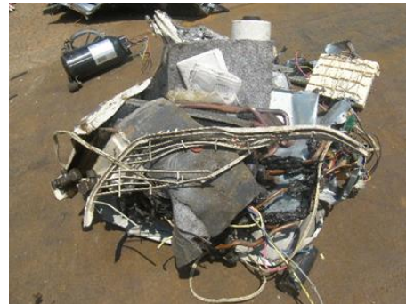
破砕されたエアコン室外機
