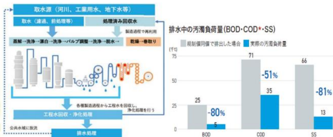
排水の循環フロー（簡易図）と排水中の汚濁負荷量
