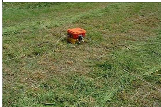
電線と受信機の設置状況
