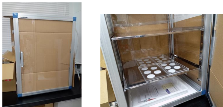
図5 フィルタ乾燥時のガス置換デシケータの遮光例(左:外観、右:内部)
