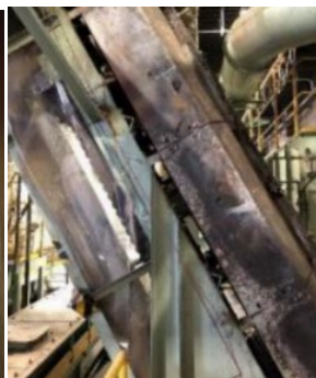
火災で焦げた破砕物コンベヤ （府中市）
