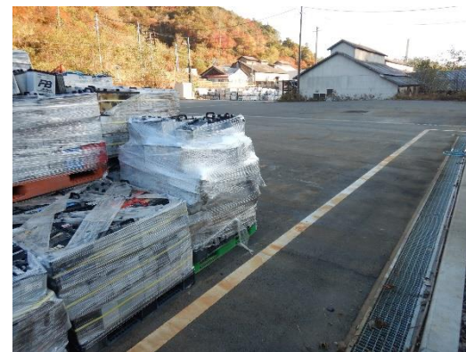
アスファルト舗装の上で保管し、側溝で漏れ出た鉛を含む電解液(硫酸)は全て回収している。
