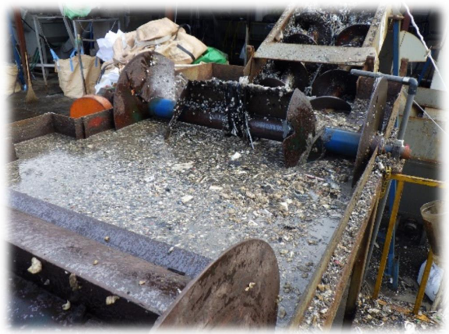
【写真】雑品スクラップの洗浄に伴う汚水の流出
