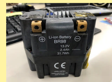
2輪用始動用Li-ionバッテリー(ヤマハ) (外寸90×110×70)
