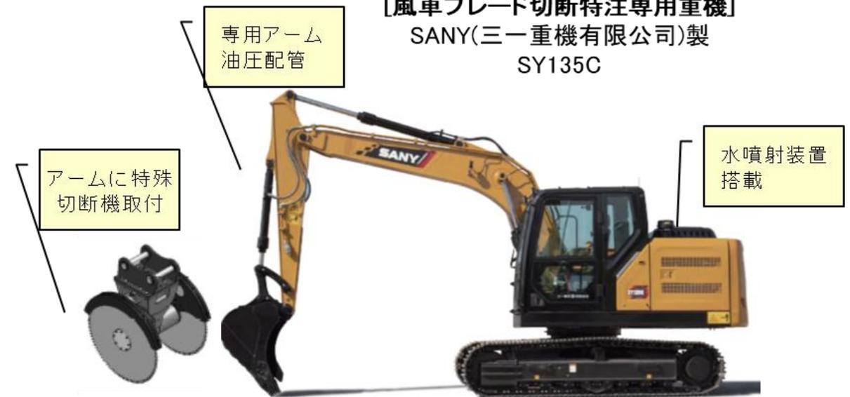
すべてのプレート解体現場対応できるようにプレート1M以内切断機開発しました。
