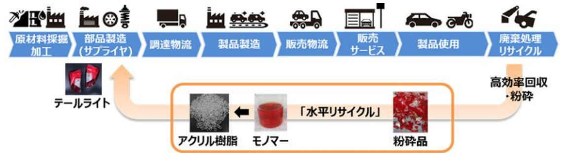
本田技研工業によるアクリル樹脂の水平リサイクル概念図
