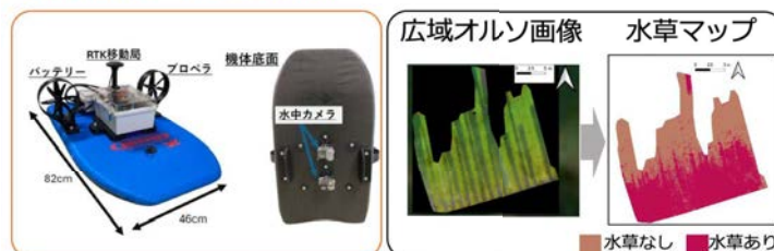
図 水草調査のための水上ドローン概要
