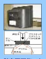
特長 赤外線を多面照射し、従来不可能であった 黒色プラスチックの識別、表面の塗装や汚れの種類 を高精度で識別する技術
