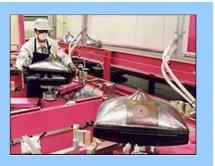
特長 CRTにヒーター線を巻き、加熱することで 熱歪を起こし、パネル、ファンネルを高精度に分割する技術
