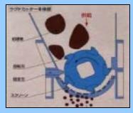
特長 エアコン、冷蔵庫のコンプレッサーを 常温で破砕し、鉄、銅、アルミに分別回収する技術
