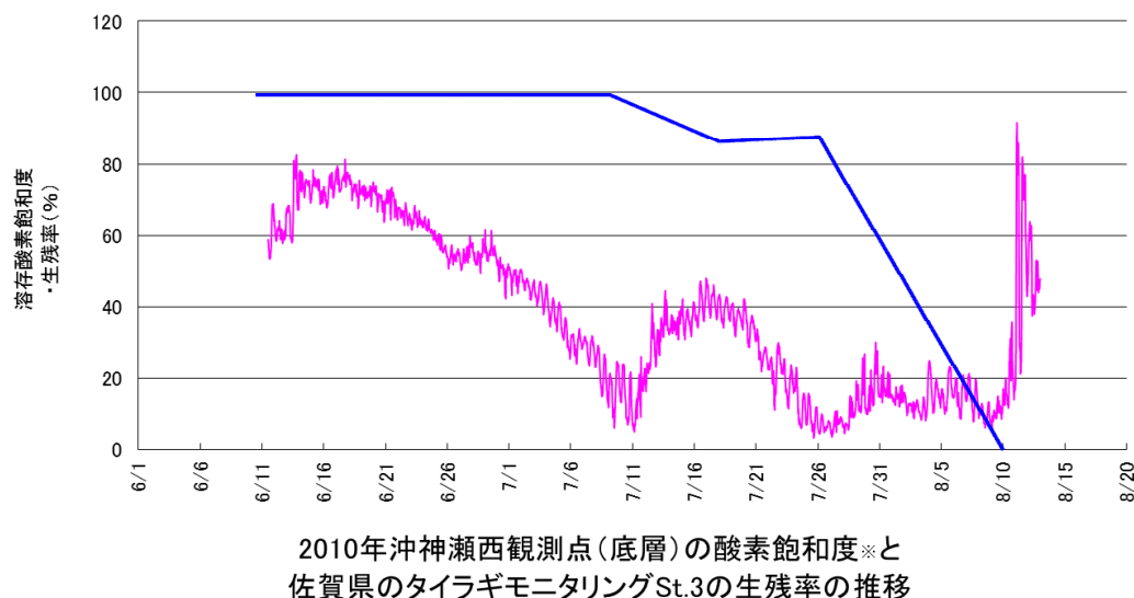
図5 2010年沖神瀬西観測点(底層)の溶存酸素飽和度とタイラギ生残率の推移 出典：水産総合研究センターの調査結果
